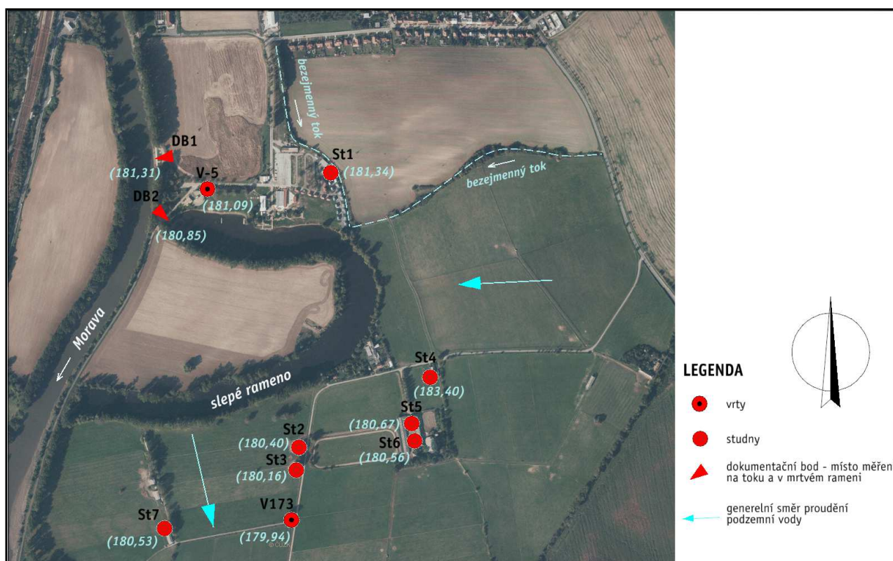
Obrázek č. 24: Poloha hydrogeologických objektů a úroveň hladiny povrchové a podzemní vody dne 23.6.2014
